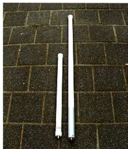
Zelfbouw 8 dBi en commerciële 15 dBi rondstraler.
